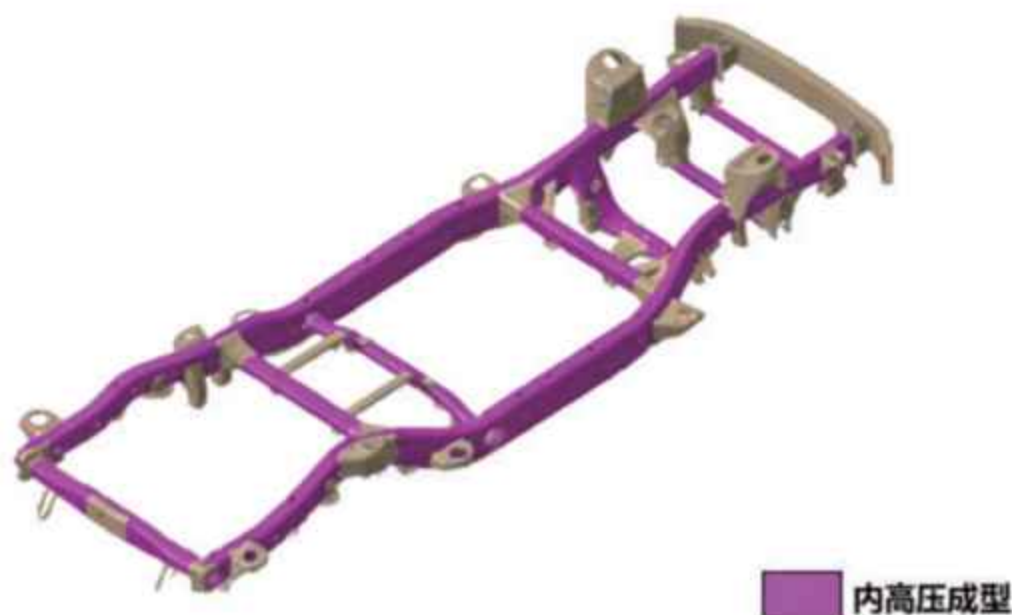
图 3-8 内高压成型的大梁车架结构
