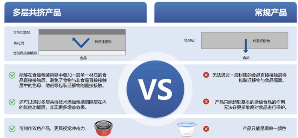
图18：多层共挤产品与常规产品对比
