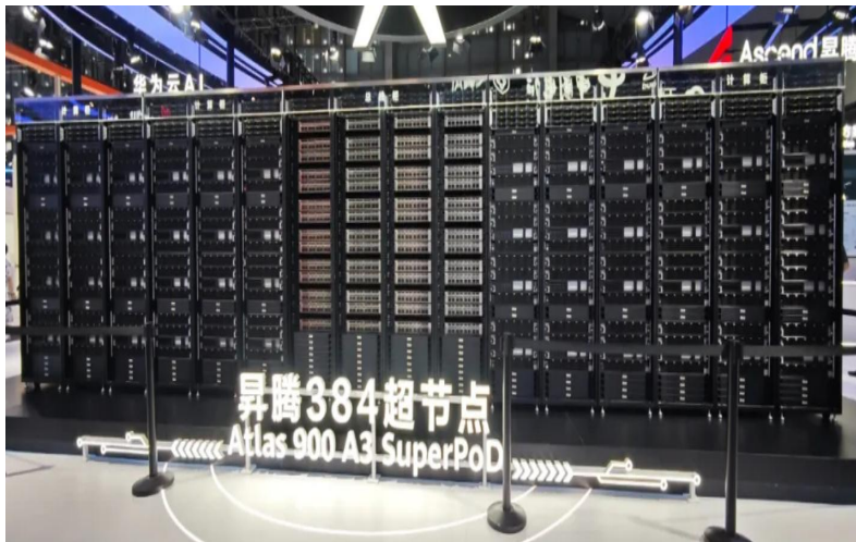
图35：华为昇腾384超节点采用液冷方案
