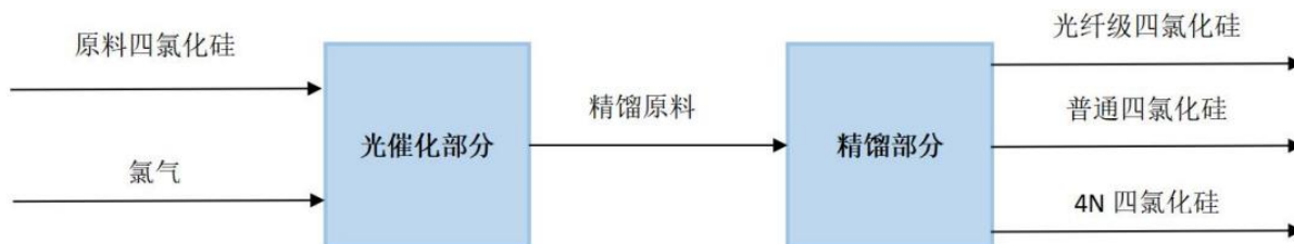
图6: 三孚股份四氯化硅精馏工艺及产品分类
