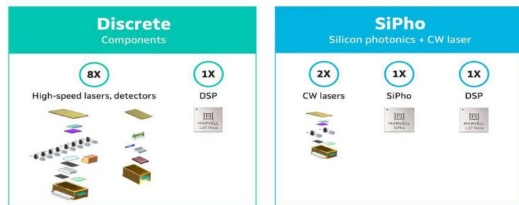
图 6：传统光模块与硅光模块组成对比图
