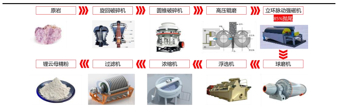
图13：“强磁抛尾+浮选提精”选矿工艺
