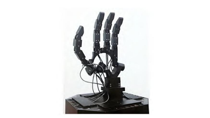
图 62：Metamorphic 灵巧手腱绳传动图示
