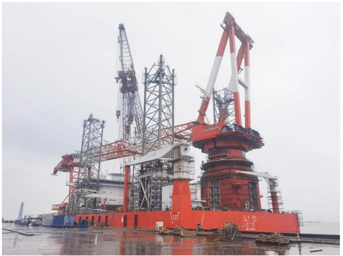
图表18: 公司联合正力开展定制化适配改造, 使其具备欧洲海上风电项目安装作业能力
