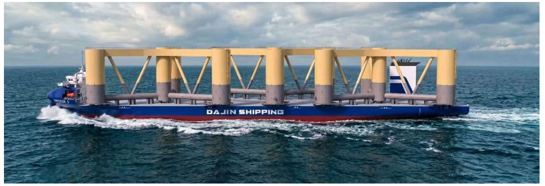
图表25: 超过 60 米的船宽使得 Emperor 系列船型具备经济运输浮式基础的能力
