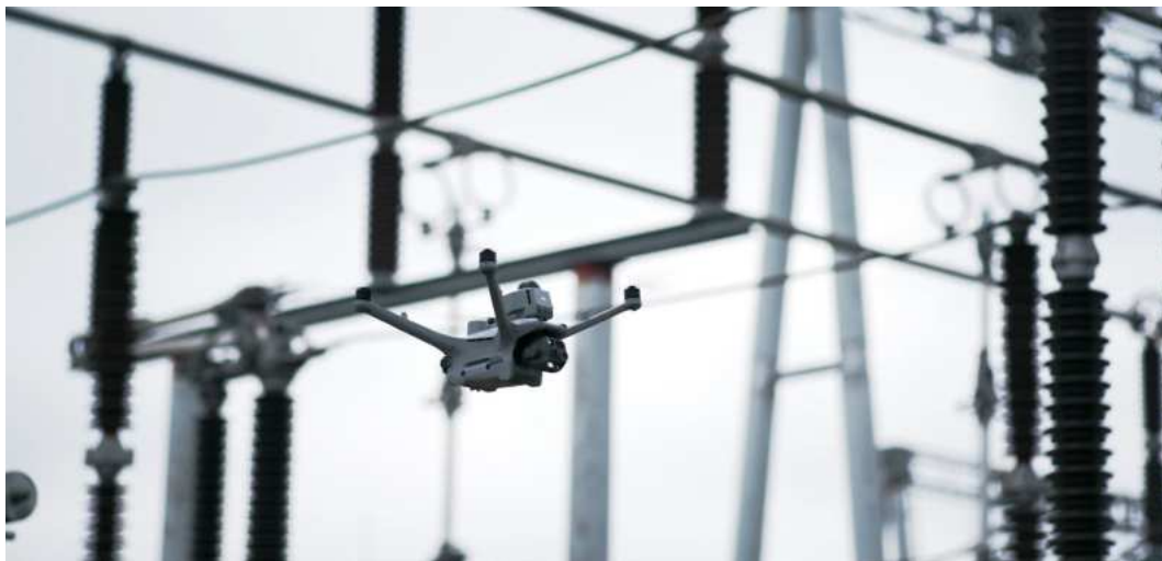
图 2-6 配备避障雷达，实现导线级避障
