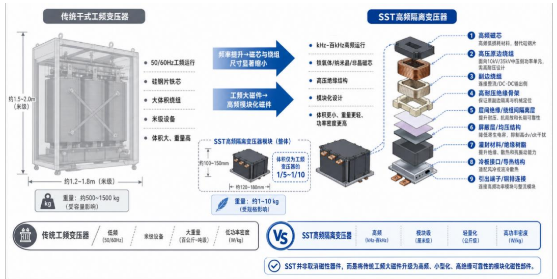
图表17: SST 高频变压器可以大幅减小变压环节的设备体积
