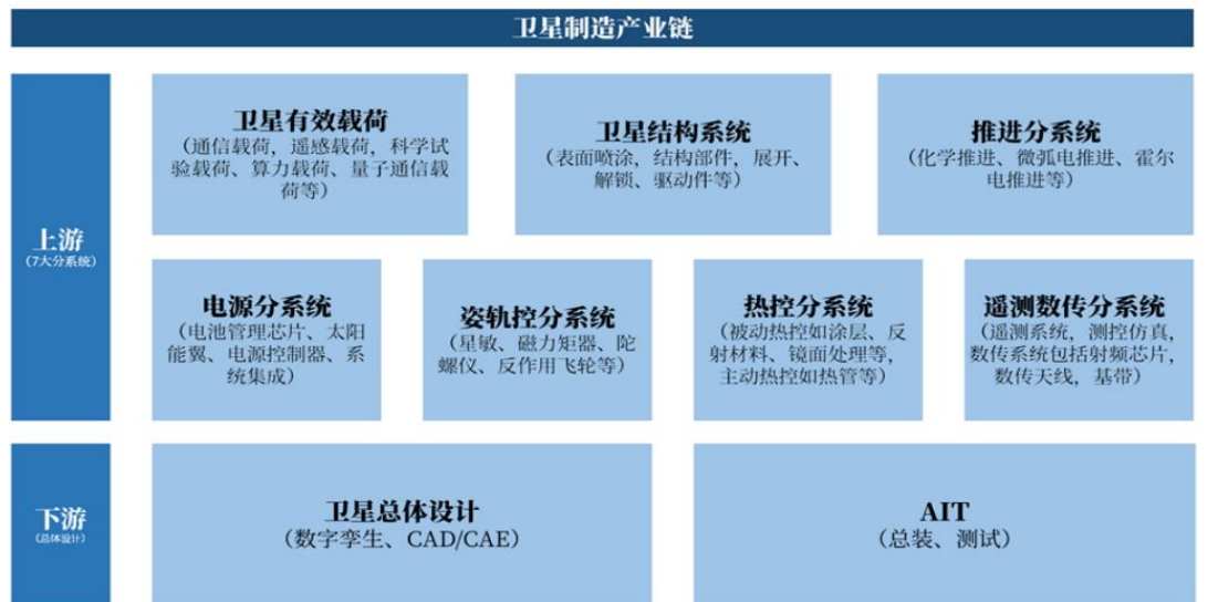
图表2：卫星制造产业链：上游7大分系统+下游总体设计与测试
