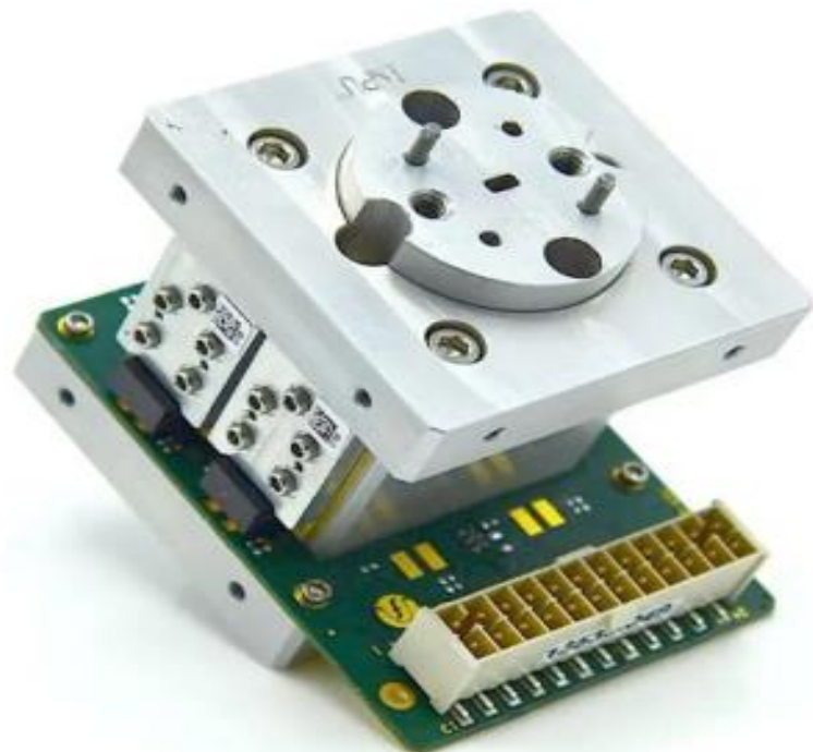
图表13: Cerus 32 固态功率放大器示意图
