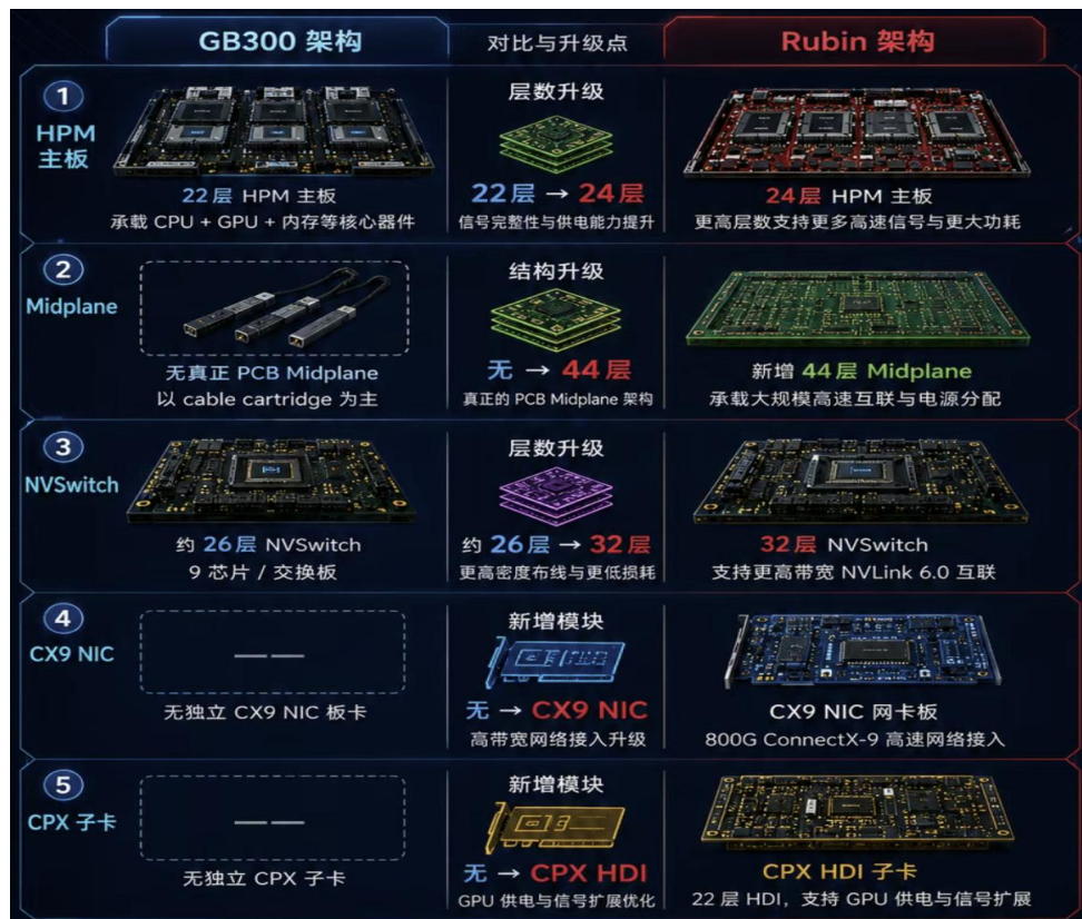
图：英伟达Vera Rubin服务器架构
