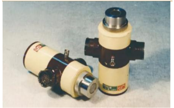
图 18：早期 60 像元长波红外探测器—应用于气象卫星、飞船
