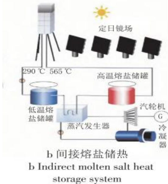
图27：间接熔盐储热系统
