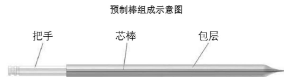
图3：光纤预制棒是圆柱形的高纯度石英玻璃棒
