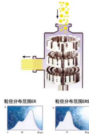
图表 24：纤维剪切沉析机工作示意图
