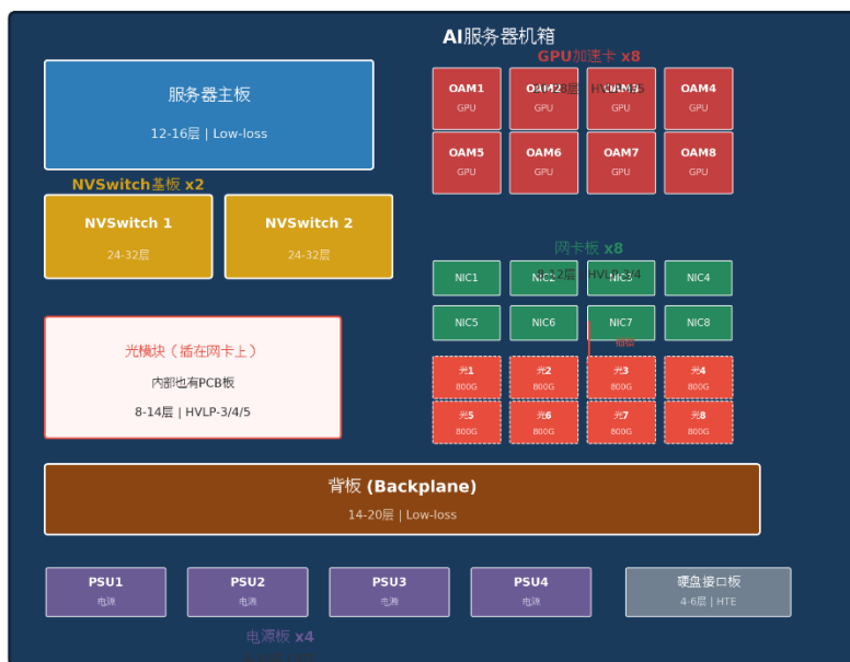
图：服务器的构成及pcb的应用
