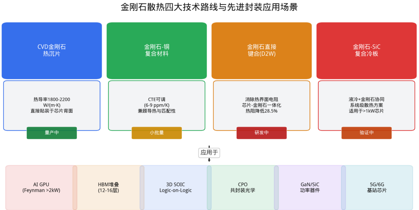
图2: 金刚石散热的四大技术路线
