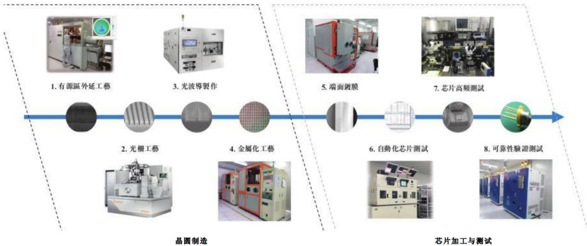
图43：CW 激光器芯片关键制造步骤及相关设备
