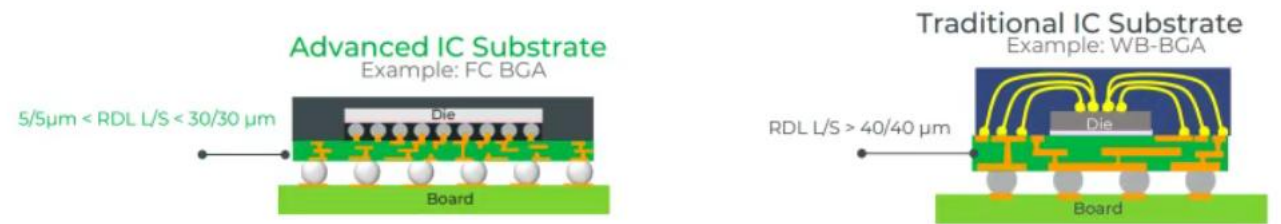
先进IC基板和传统IC基板的对比
