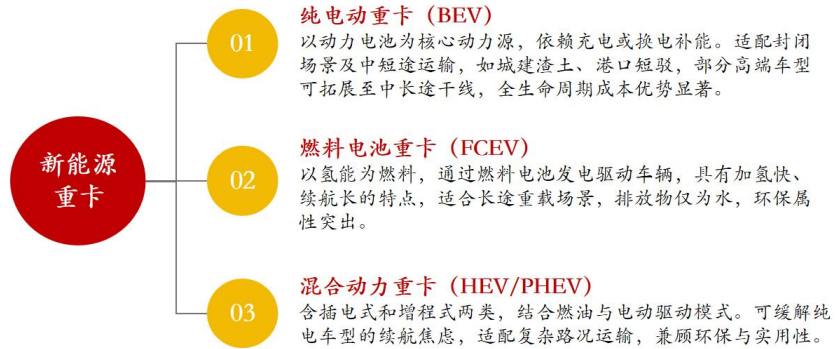
图表 2：新能源重卡主要分为纯电动重卡、燃料电池重卡、混合动力重卡
