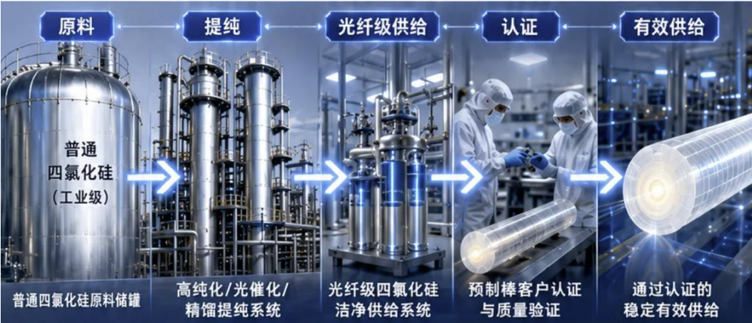
图：光纤级四氯化硅生产提纯流程
