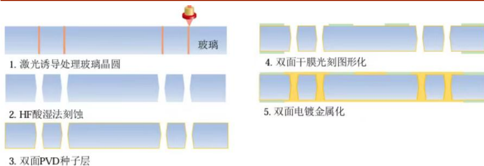
图20：双面通孔电镀 TGV 金属化工艺流程
