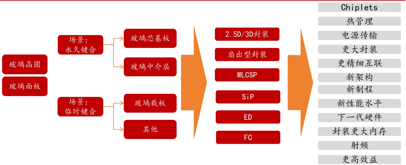
图表 9：玻璃载板/基板分别主要对应晶圆/面板的两个应用场景：临时键合和永久键合
