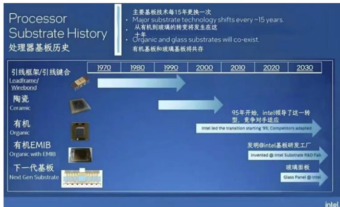
图25：下一代芯片基板为玻璃基板
