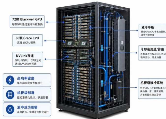
图19：NVIDIA GB200 NVL72 机柜级液冷架构示意图
