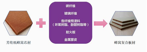
图表 36: 芳纶纸蜂窝可用于制作夹层结构复合材料
