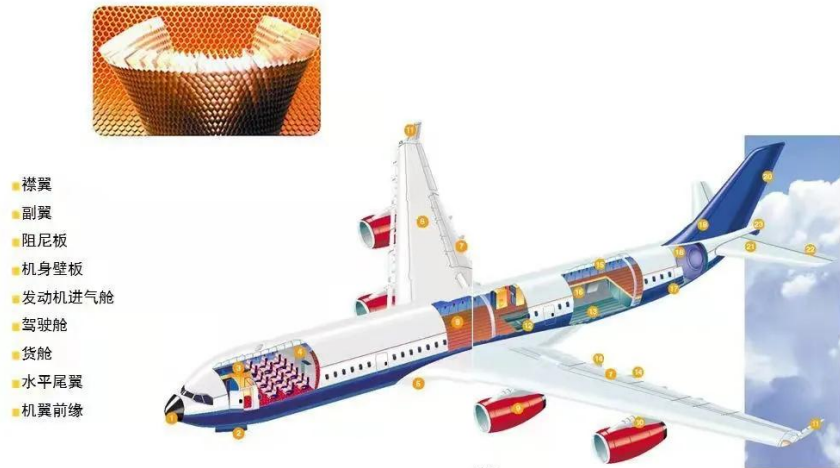
图表 38：芳纶纸蜂窝可作为飞机刚性次受力结构材料，应用在机身、机翼等多个场景
