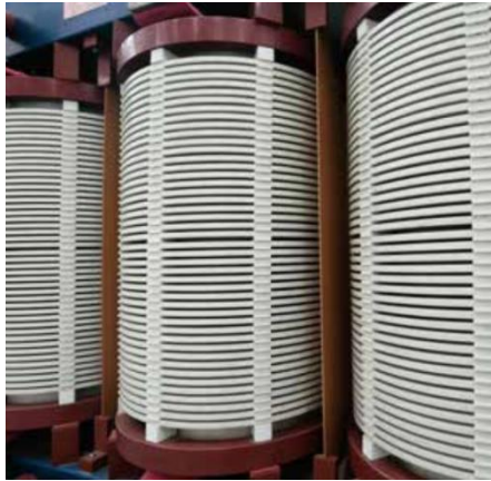
图表 5：芳纶纸在干式变压器应用示意图
