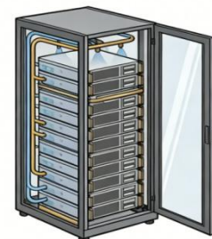
图表 26：液冷系统主流部署形态可划分为卧式 Tank 与立式机柜两大类
