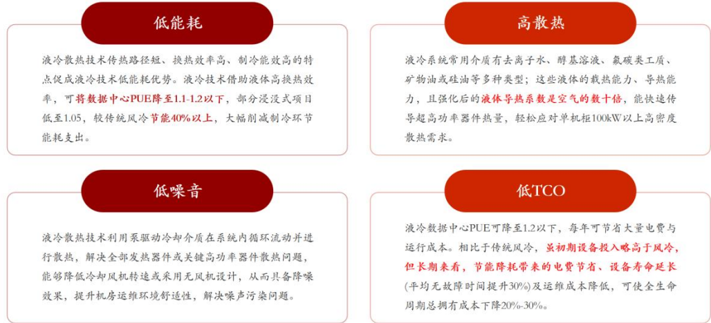
图表 7：液冷技术主要有低能耗、高散热、低噪音等优势
