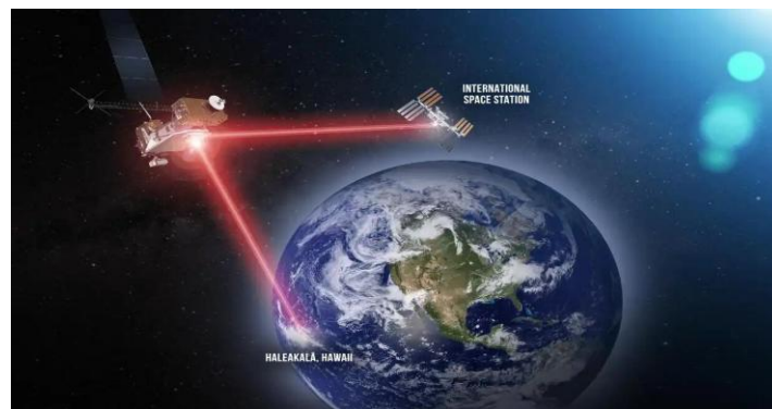
星间激光通信示意图
