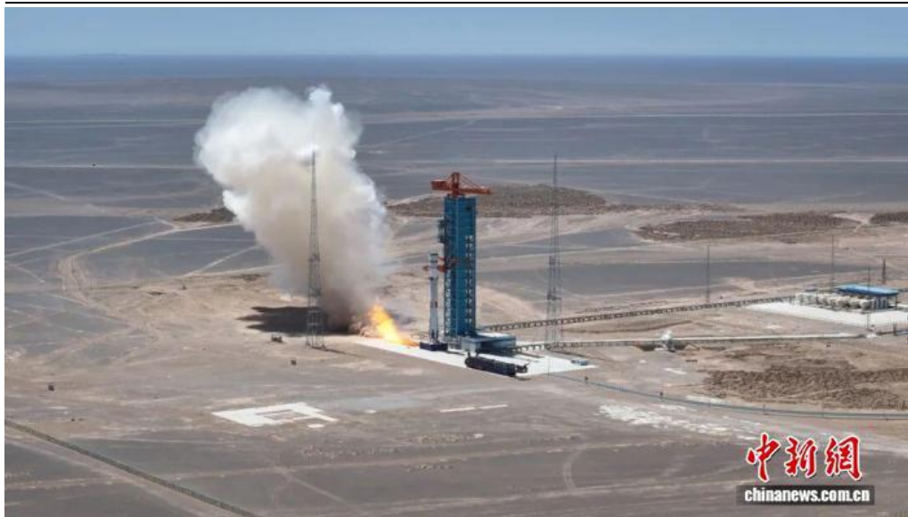
图1：朱雀三号遥二火箭在东风商业航天创新试验区顺利完成静态点火实验
