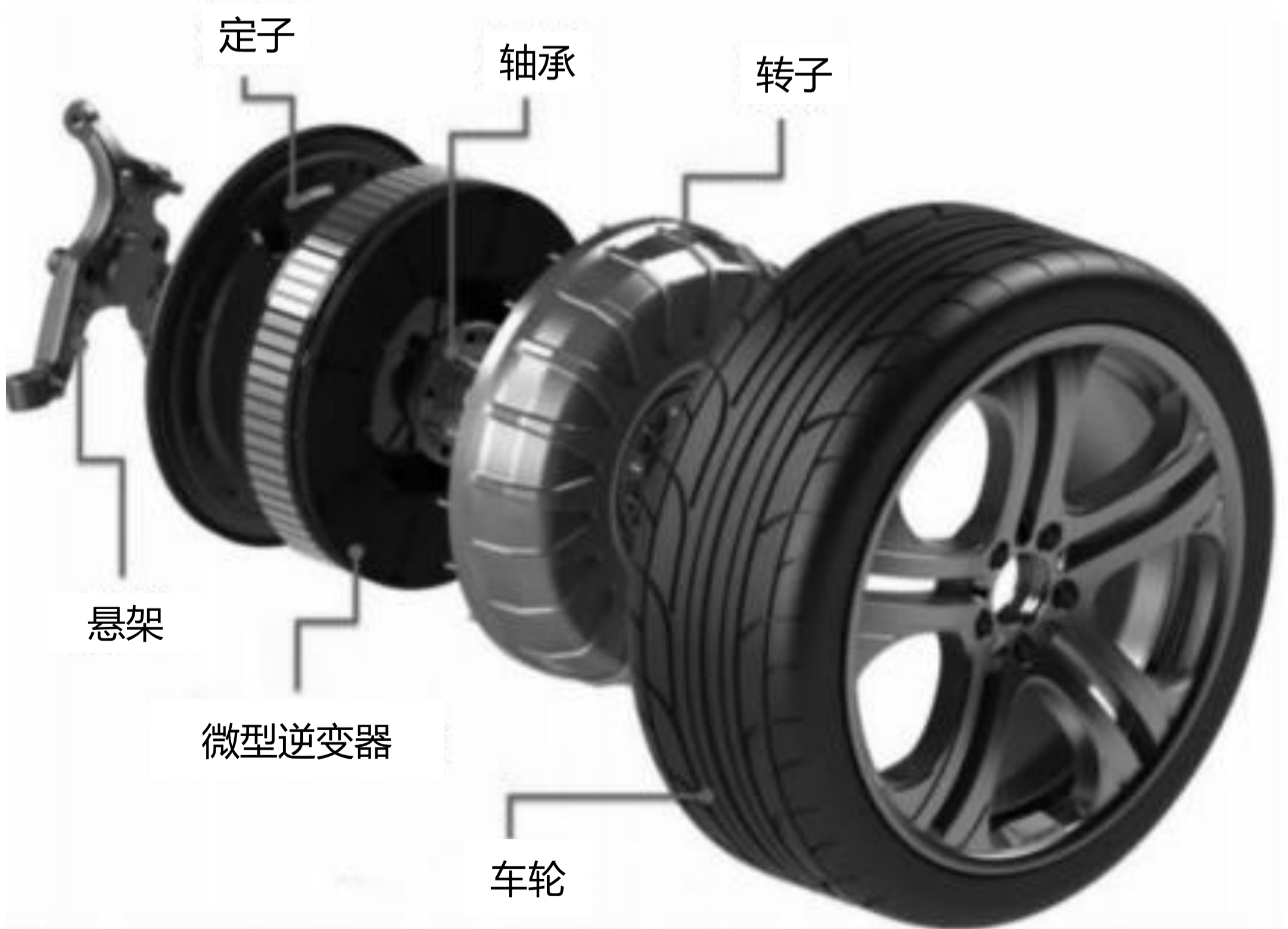
图4 轮毂电机拓扑结构
