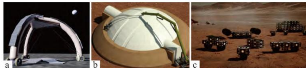
(a) 龙门架打印机 [108] (b) 机械臂打印机 [109] (c) 移动建造机器人人群 [110]
