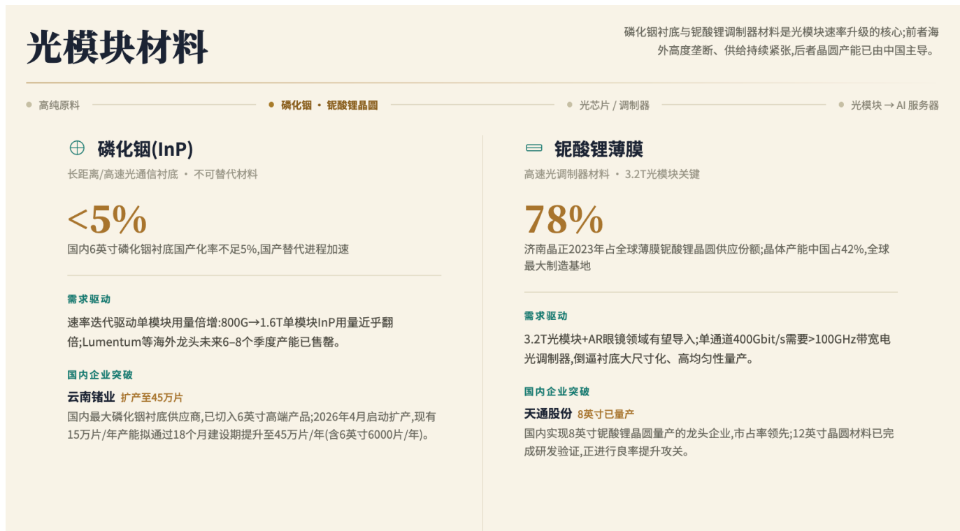
图12：光模块材料是高速光通信器件的核心上游，包括磷化铟、薄膜铌酸锂等
