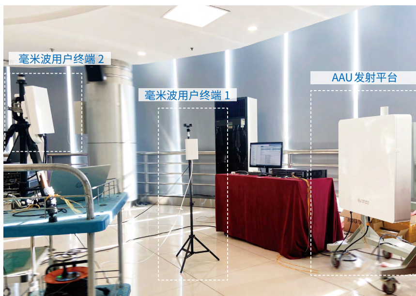
图 20 - 基于全息超表面的无线通信系统样机
