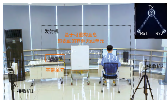
图 16 - 毫米波全息超表面宽带高速通信系统 (双用户传输为例)
