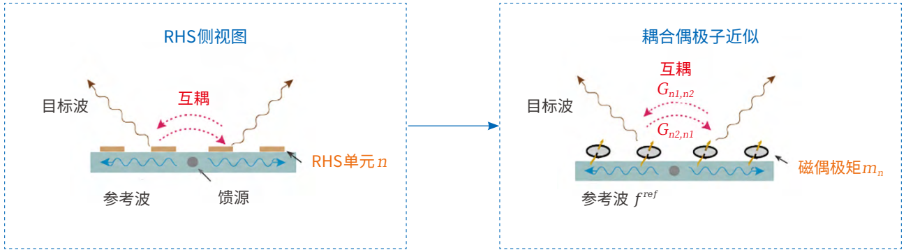
图 11 - 用于建模全息超表面间互耦效应的耦合偶极子近似模型示意图
