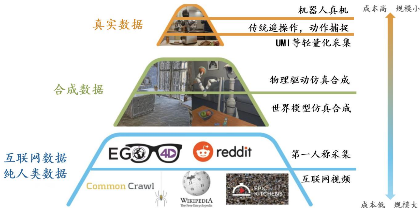
图表11：数据金字塔中真实数据规模远小于合成数据、互联网数据和纯人类数据
