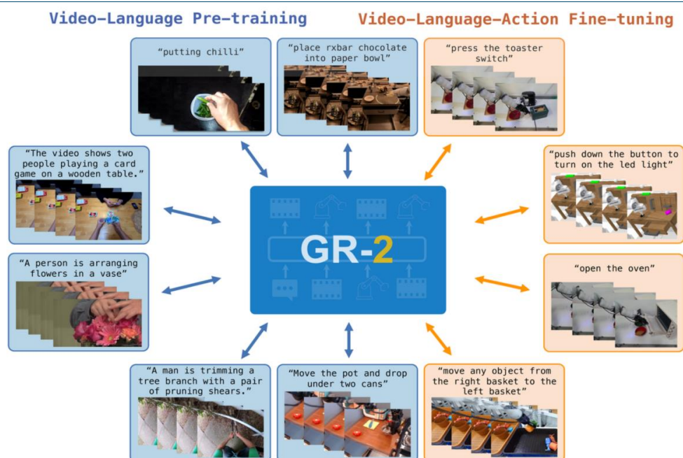
图表25：字节跳动 GR-2 采用 VL 预训练+VLA 微调的架构
