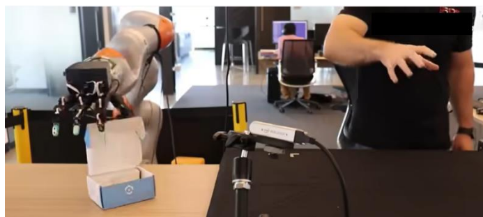
图表18: 通过视觉相机可以捕捉人类动作并投射到机械手臂
