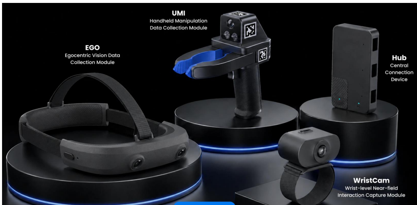
图表38：奥比中光已推出完善的 UMI、EGO 等无本体数据采集设备
