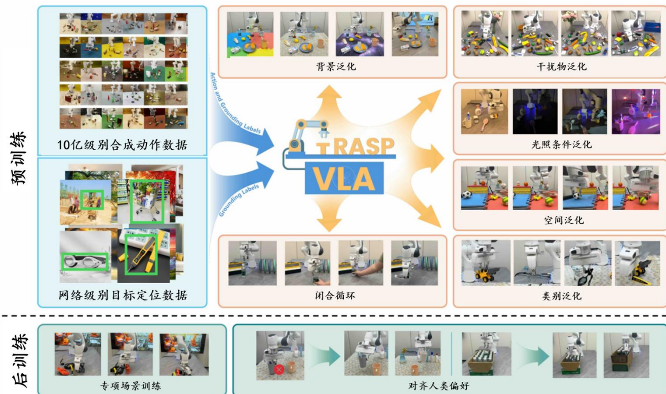
图表59: 银河通用 GraspVLA 使用全仿真数据预训练+真实数据微调的架构
