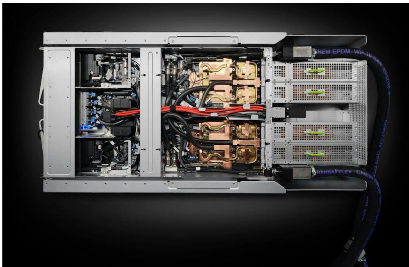
图表6: NVIDIA 的 GB300 计算盘采用了水冷，但由于布线和管道复杂，制造起来更为困难
