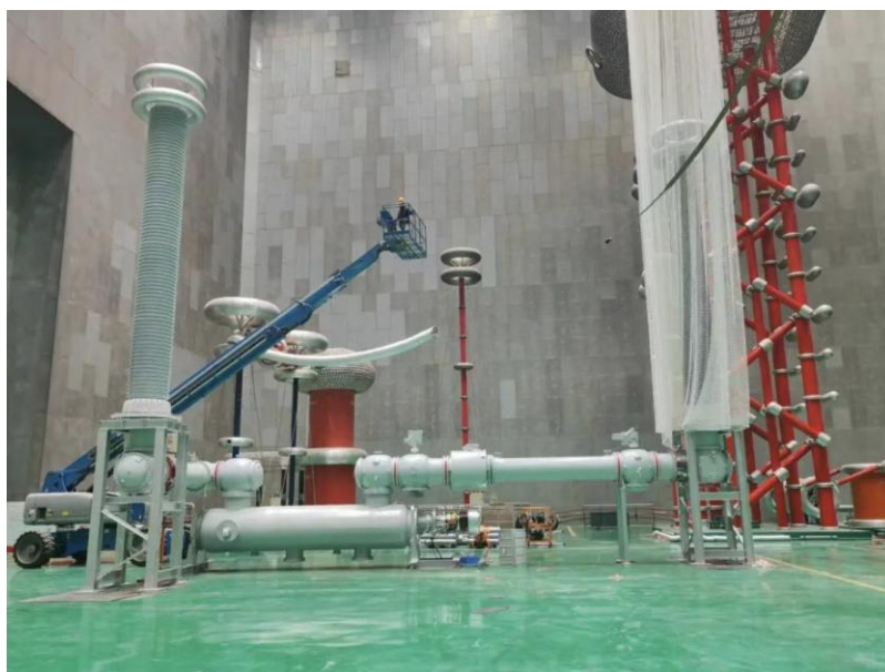
图14: 公司研发的 800kV GIS 样机
