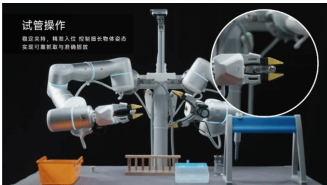
图表8：千觉机器人 X-TouchMind V1 试管精细操作任务演示
