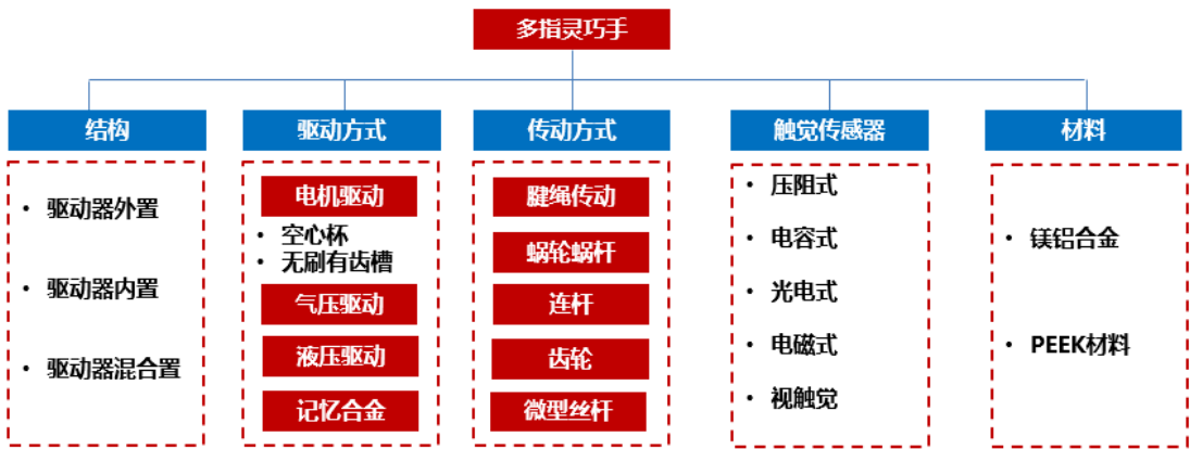
图31：灵巧手机械运动、感知系统、材料构成
