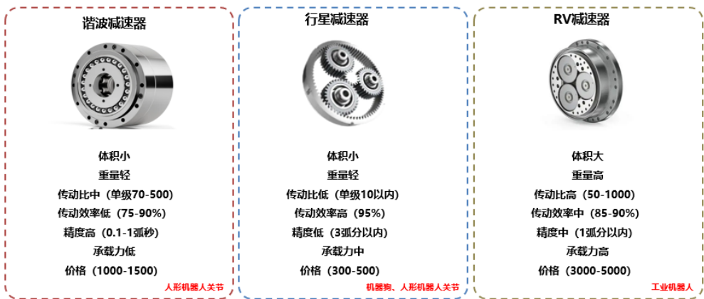
图19：谐波减速器 VS 行星减速器 VS RV 减速器
