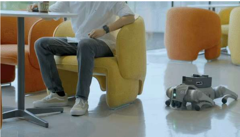
图表：搭载Qwen-RobotNav的机器狗顺利完成寻物导航
