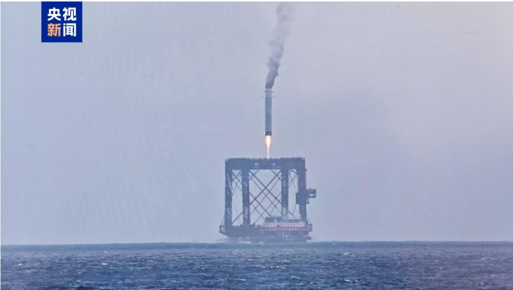
图：长征十号乙运载火箭成功实现一子级网系可控回收
