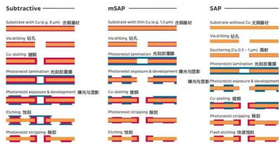
图： 减成法-mSAP-SAP加工工艺流程对比
