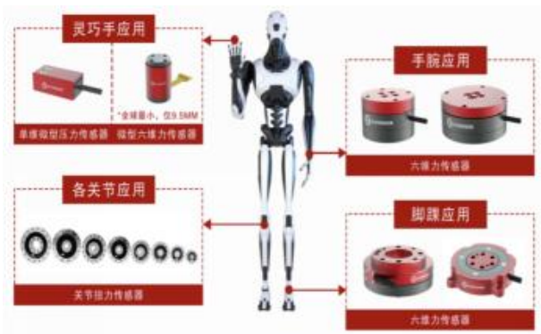
图225: 人形机器人中六维力传感器应用位置
