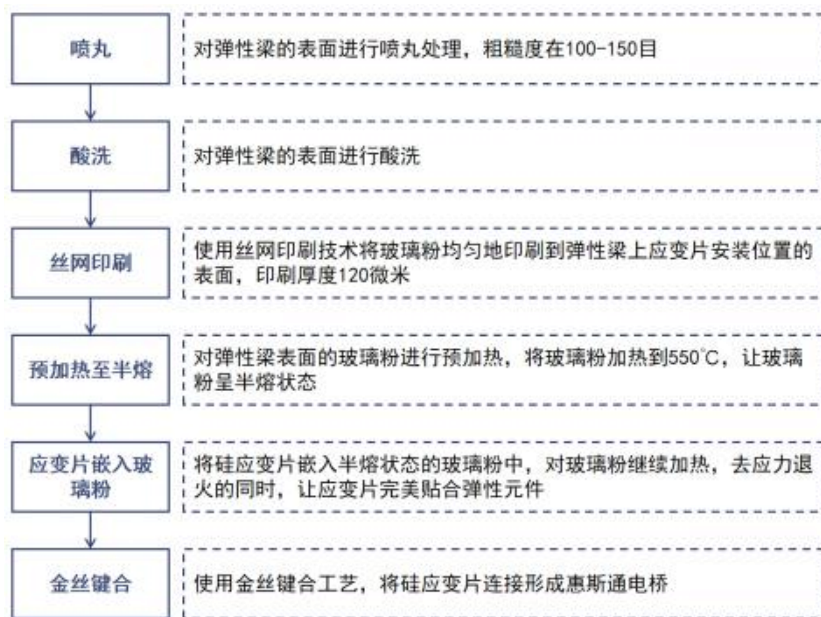
图 254：硅基应变片玻璃微熔工艺制备方法
