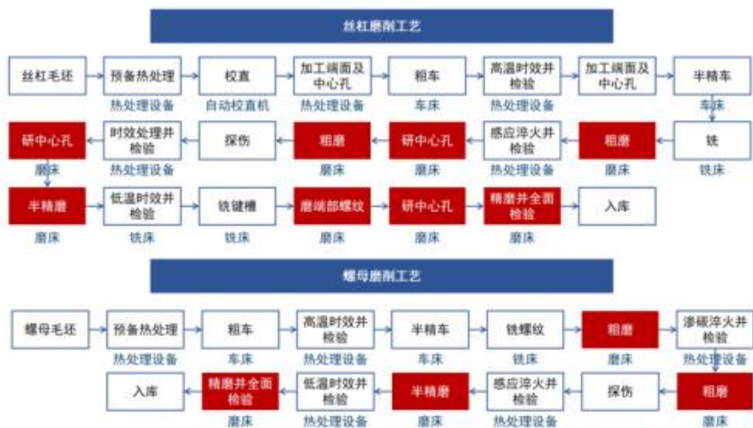
图200：行星滚柱丝杠的磨削加工工艺流程
