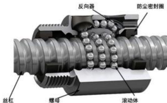
图177：滚珠丝杠结构
