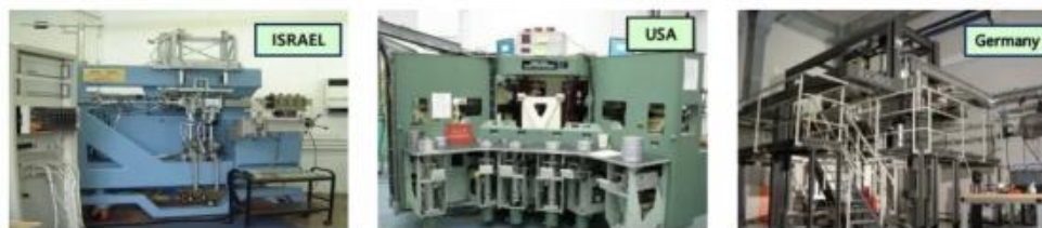
图250：各国六维力传感器标定设备形态不一
