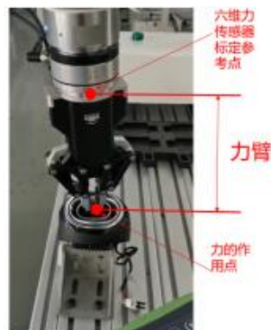
图226: 六维力传感器在机器人末端的应用
