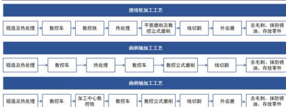
图162: 摆线针轮减速器重要工艺
