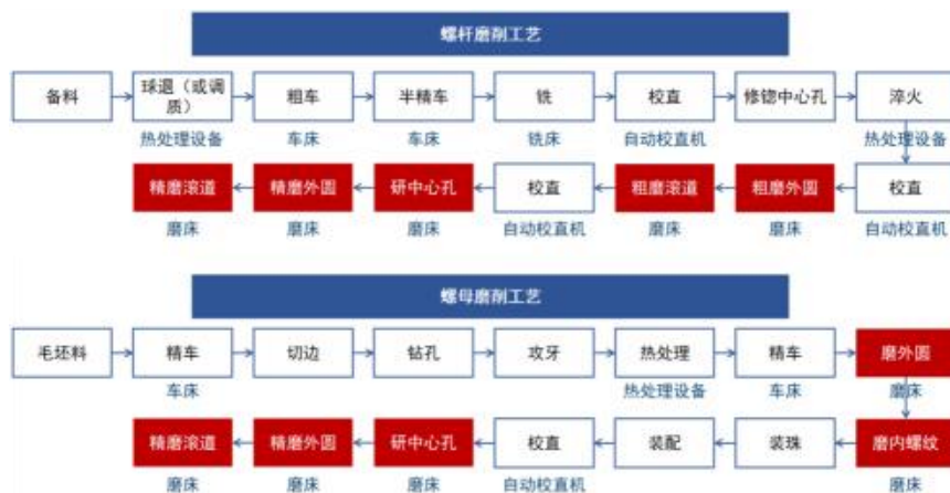
图199：滚珠丝杠的磨削加工工艺流程
