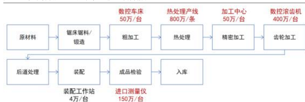
图129：绿的谐波产品生产流程及使用设备情况
