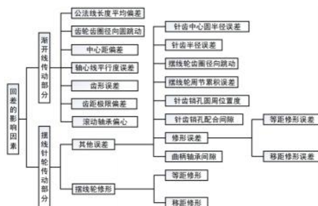
图 134: RV 减速器回差影响因素多
