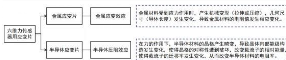
图 238：应变式六维力传感器主要采用硅应变片或金属应变片
