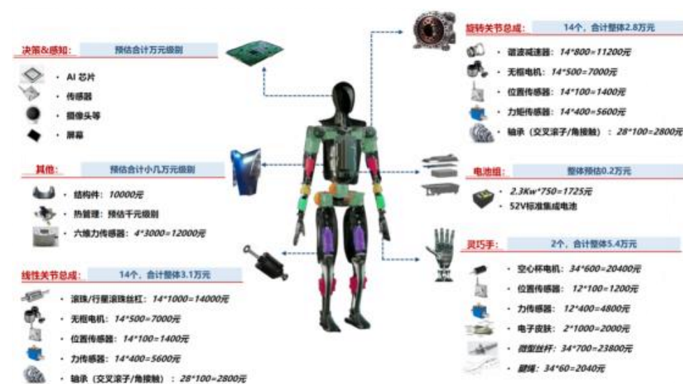
图13：人形机器人硬件拆解
