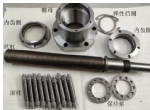
图183：行星滚柱丝杠零部件
