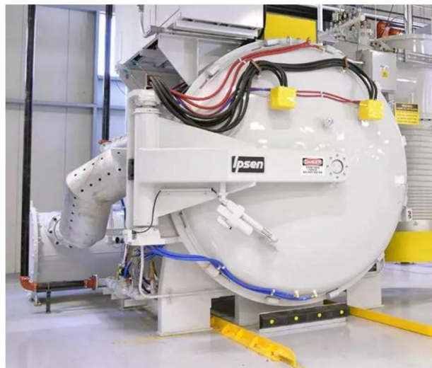
图表45: 真空钎焊炉是高端换热器专用设备
