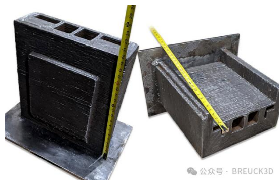
图表 13：3D 打印随形冷却模具镶件
