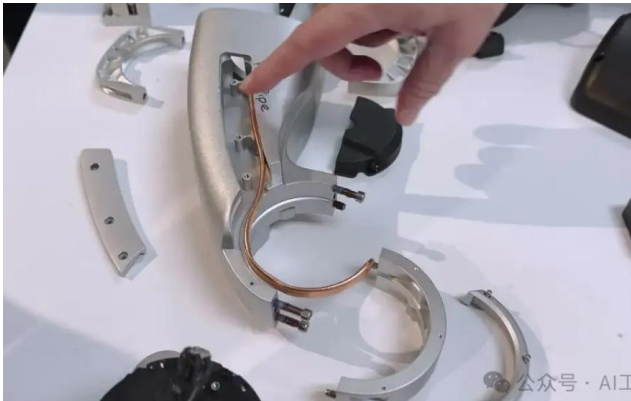
图表 57. 宇树科技 G1 的热管导热结构
