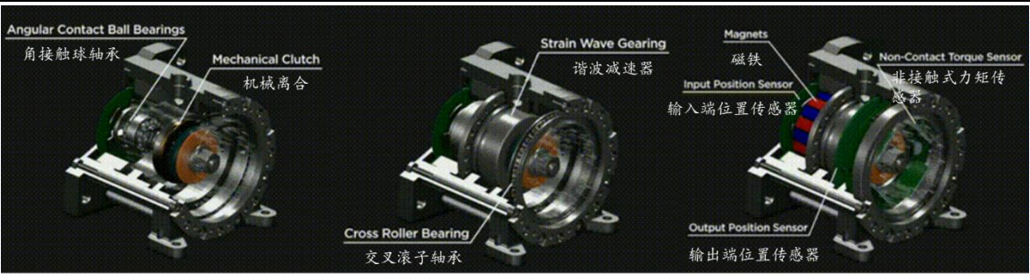
图表 24.特斯拉旋转执行器主要构造
