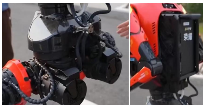
图表 60. 荣耀机器人“闪电”的液冷散热系统
