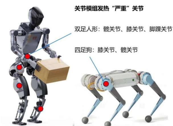
图表 52. 机器人关节热源
