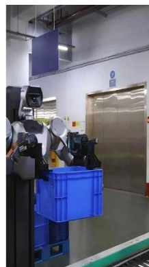
银河通用 | Galbot S1 双臂50kg、续航8h；进入宁 德时代电池模组及电池包相 关工序产线常态化运行
