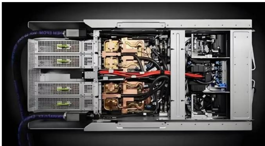
图37：英伟达微通道液冷散热板
