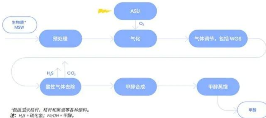
图23：生物质气化制甲醇工艺流程图
