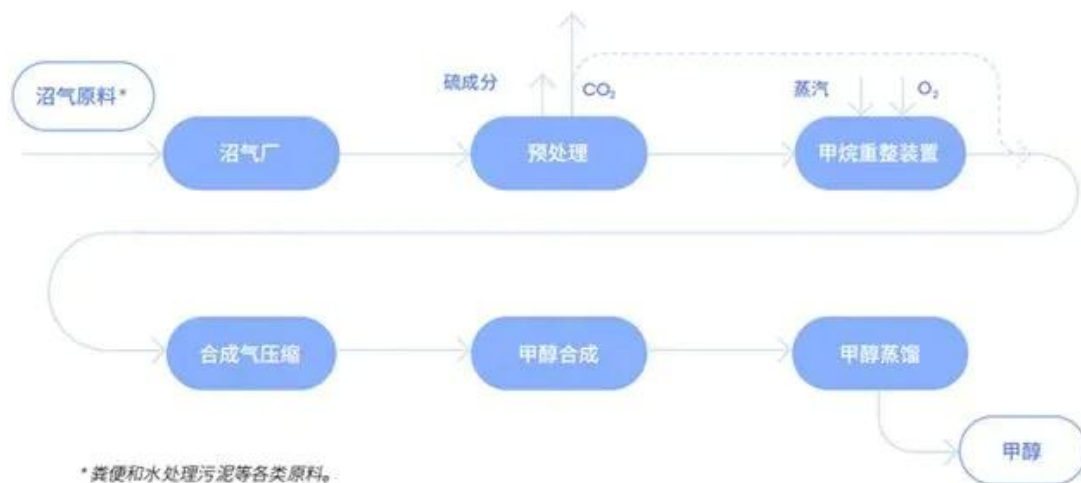
图22：生物甲烷制甲醇工艺流程图
