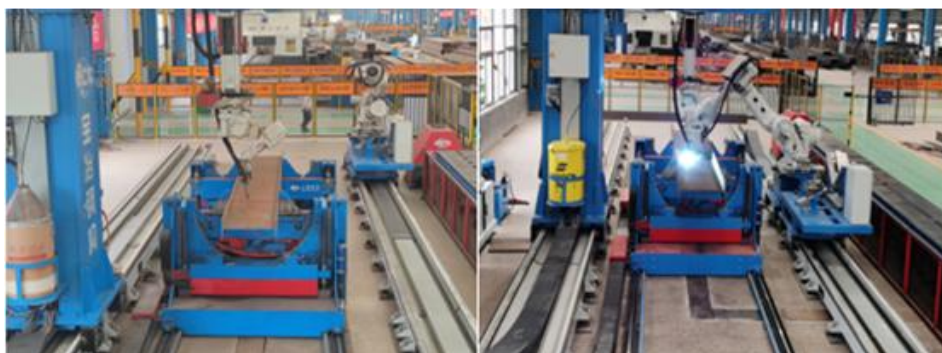
图 3.1.6-7 H 型钢焊接制作
