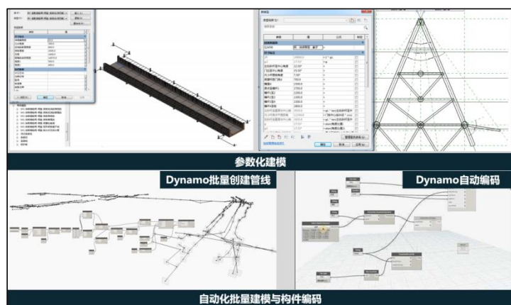
图 3.1.3-4 基于 Dynamo 的 BIM 参数化建模
