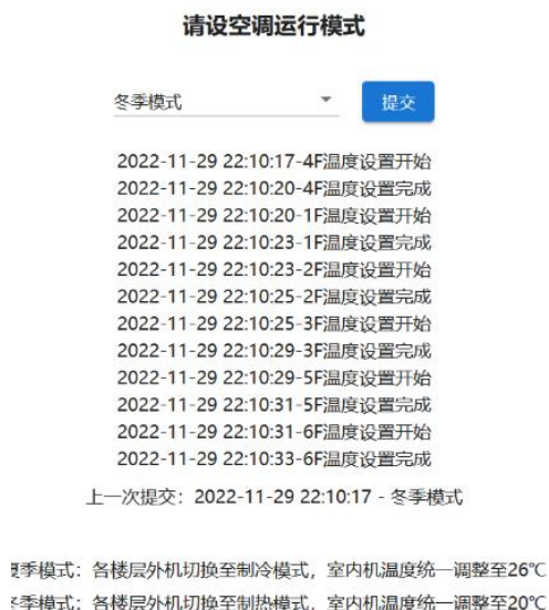
图 3.3.4-6 空调系统换季切换冷热模式
