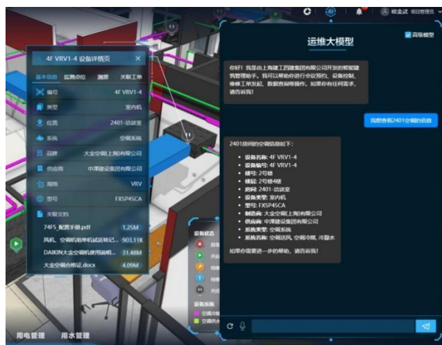
图 3.2.4-2 大模型查询 BIM 信息
