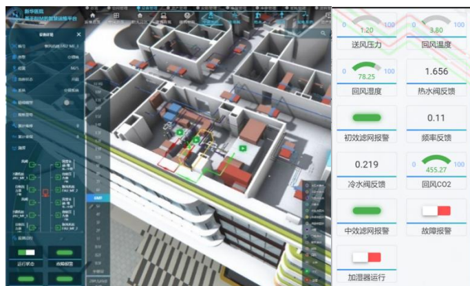
图 3.3.4-3 设备的运行参数及故障设备详情
