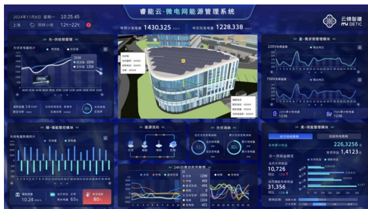
图 3.3.5-2 基于 BIM 微电网能源管理系统
