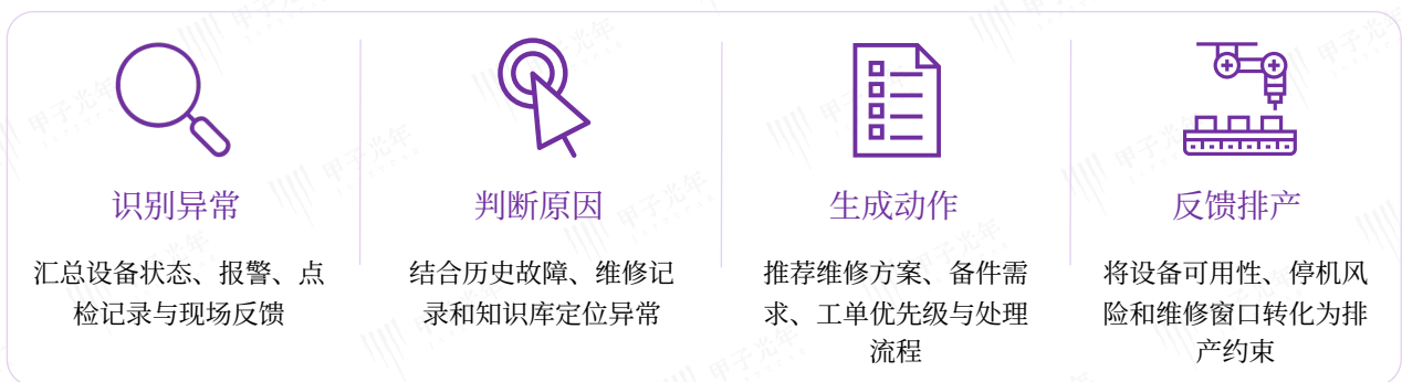
图：设备运维Agent能将设备管理系统形成闭环
